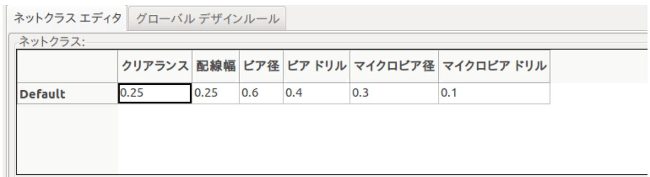
4. グローバルデザインルールタブをクリックし、最小配線幅を *0.25* に設定します。変更を確定するには OK ボタンをクリックし、デザインルールエディターのウィンドウを閉じます。
