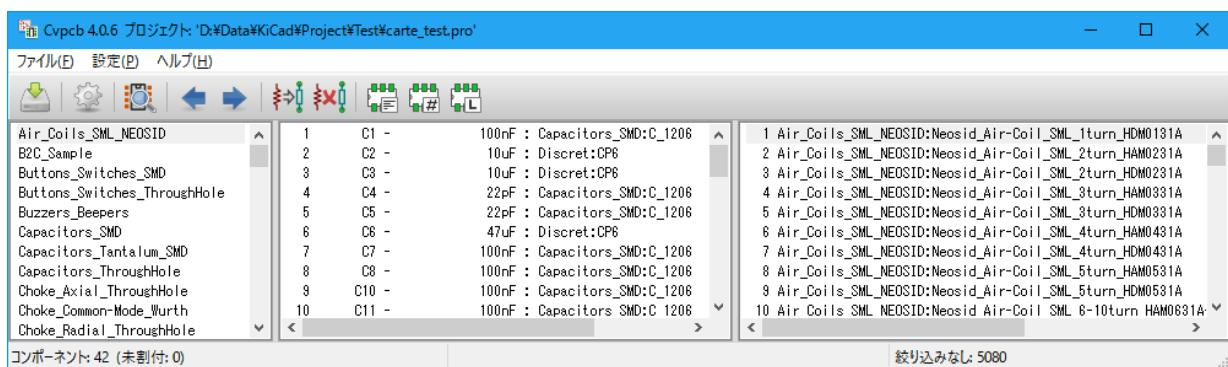
左側のウィンドウには、プロジェクトで有効なフットプリントライブラリのファイル名がリスト表示されます。中央のウィンドウには、ネットリストファイルから読み込まれたコンポーネントのリストが表示されます。右側のウィンドウには、ロードされたライブラリに含まれるフットプリントのリストが表示されます。ファイルがロードされていない場合にはコンポーネントウィンドウは空白であり、フットプリントのライブラリが見つからない場合にはフットプリントウィンドウは空白です。
