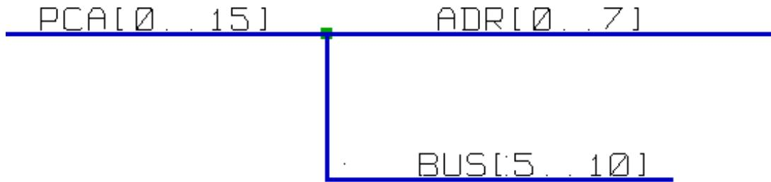
バス PCA[0..15], ADR[0..7], BUS[5..10] は互いに接続されています。(接続点に注意してください。縦方向のバスが横方向のバスの中間に接続されています。)
