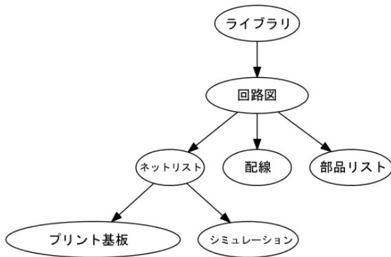
シンボルはシンボルライブラリーから回路図へと配置されます。回路図が完成した後で、PcbNew が回路の接続情報とフットプリントをインポートできるように、ネットリストが作られます。
